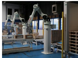
Systeem met 3x Kawasaki RD080N bij Barry Callebaut (B) dozen van 3 lijnen
