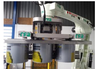
Kawasaki CP180L bij Akzo Nobel (B) emmers met verf palletiseren
