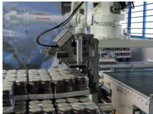
Kawasaki RD080N Aarts Conserven met hoge capaciteit trays palletiseren
