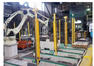
Kawasaki CP300L at Tata Steel vuurvaste stenen palletiseren
